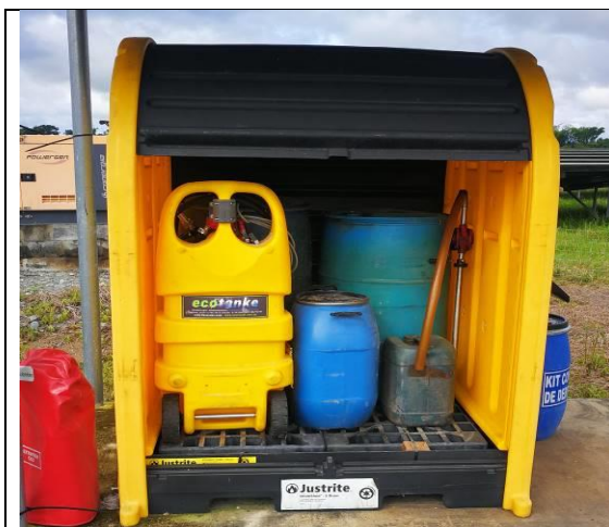
Foto 27. Armario de almacenamiento de combustible
