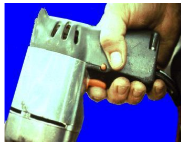
Interruptor de presión constante Interruptor de encendido/apagado corta la energía al soltarlo
